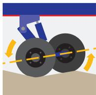
Тандемные колеса обеспечивают плавность при движении по неровным полям и дорогам, так же смягчают ударные нагрузки на оси колёс.
