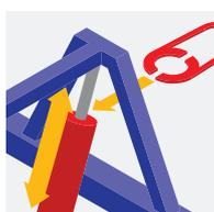
Конструктивные особенности позволяют настраивать агрегат в горизонтальное положение при помощи гидроцилиндров.
