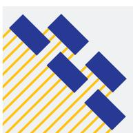
Шахматное расположение борон обеспечивает сплошную (100%) обработку почвы.
